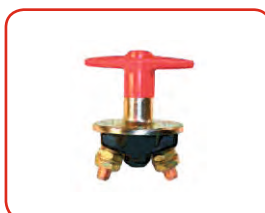
MAX 24 V - 300 A 1000 A x 10 s Con maniglia fissa / With fixed handle Cod. 40042
